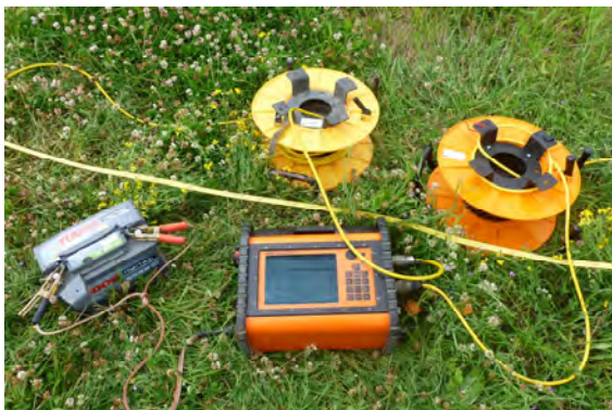
Dispositif de la mise en place d'un panneau électrique sur le terrain
